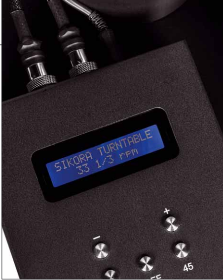
Das Display bietet Auskunft über den Betriebszustand des Antriebs
